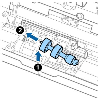
10. 將新的分紙滾輪轉軸插入右側的凹槽，然後放下滾輪。
