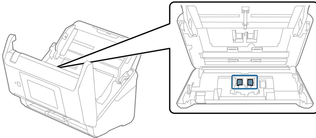
7. 使用 Epson 原廠清潔套件或沾濕的軟布擦除分紙滾輪上的灰塵。
