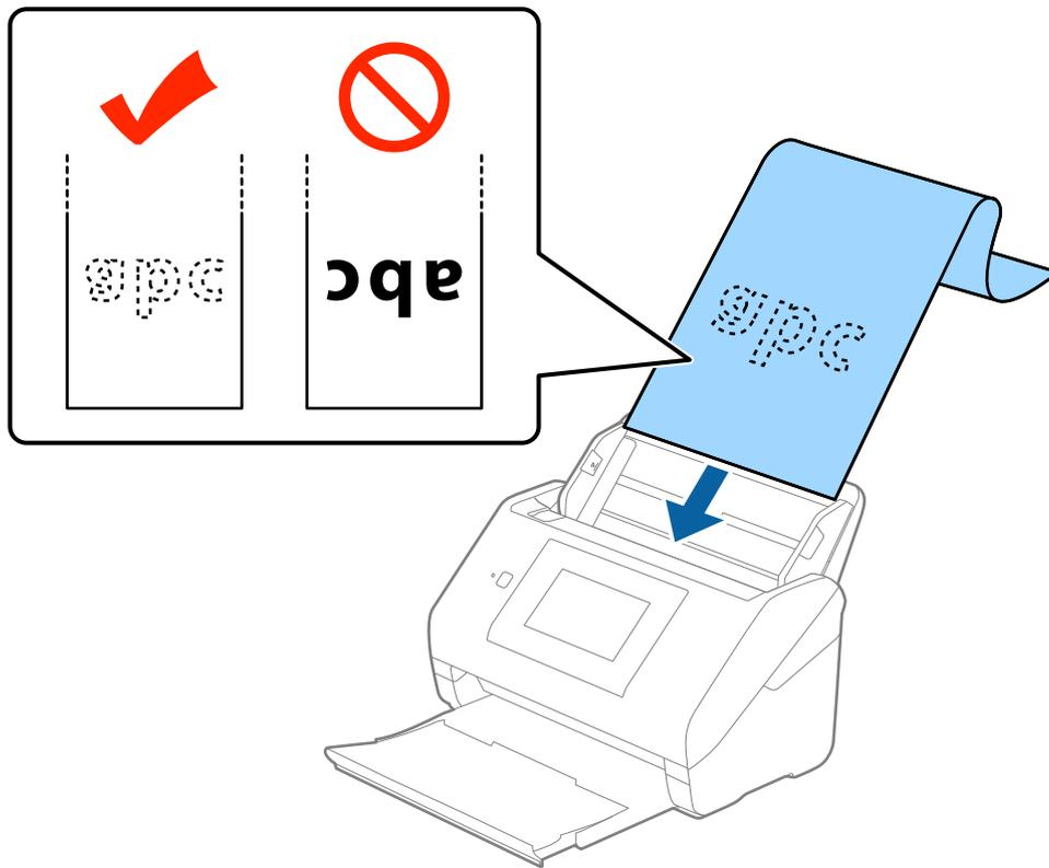
4. 調整紙張邊緣定位器以貼合長條紙，確保紙張邊緣和紙張邊緣定位器之間無間隙。否則，原稿在進紙過程中可能會發生偏斜。
