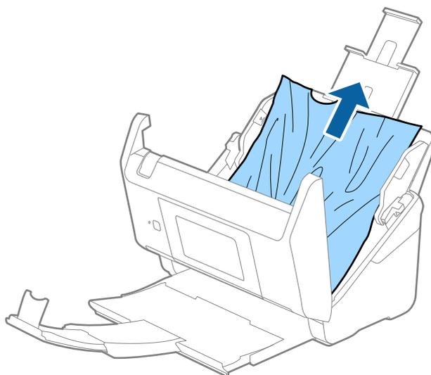
4. 如果您無法向上拉出原稿，請依照箭頭方向從出紙托盤中拉出任何夾住的原稿。
