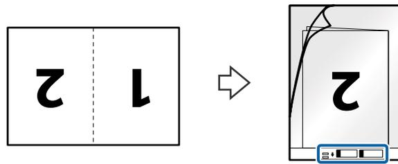
4. 將 掃描專用護套 放入進紙托盤，頂部邊緣朝向 ADF。
