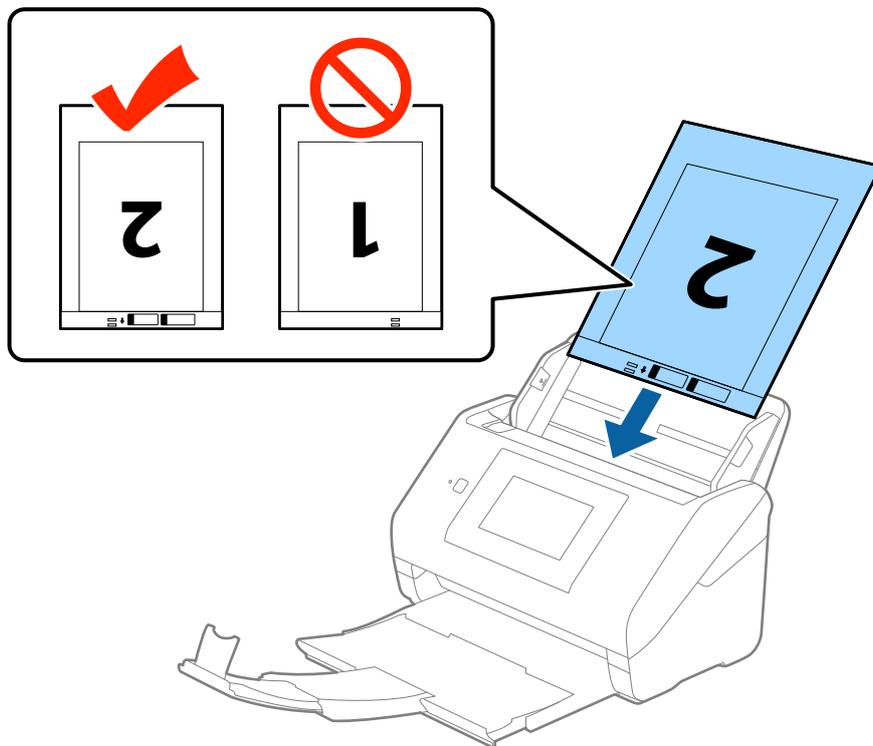
5. 滑動紙張邊緣定位器以貼合 掃描專用護套 邊緣，確保 掃描專用護套 和紙張邊緣定位器之間無間隙。否則，掃描專用護套在進紙過程中可能發生偏斜。
