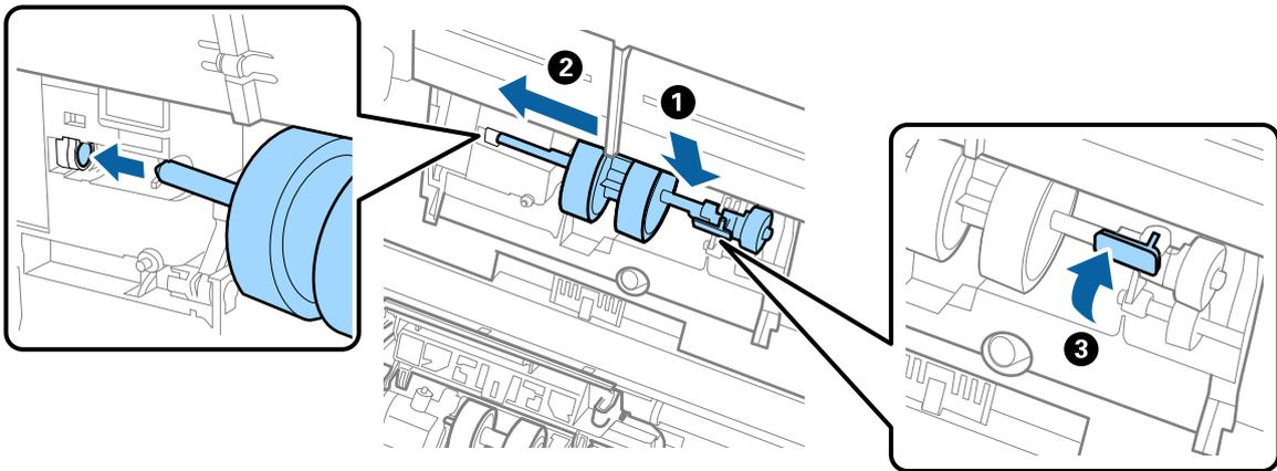
7. 將取紙滾輪護蓋邊緣放入溝槽中並滑動。闔緊護蓋。
