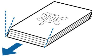
5. 將原稿的正面朝下，放入進紙托盤，並將頂部邊緣朝向 ADF。
