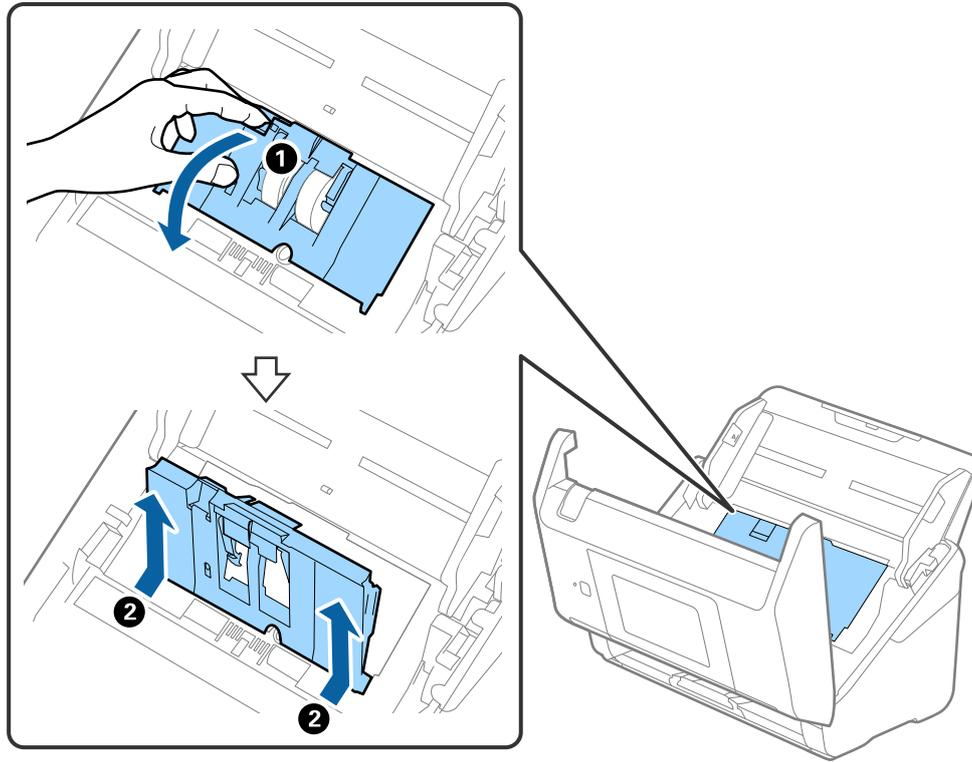
5. 拉下滾輪轉軸上的固定裝置，然後滑動並取出先前安裝的取紙滾輪。
