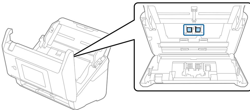
9. 使用 Epson 原廠清潔套件或沾濕的軟抹擦除取紙滾輪上的灰塵。
