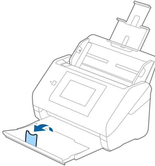
2. 將進紙托盤上的紙張邊緣定位器向外滑到底。
